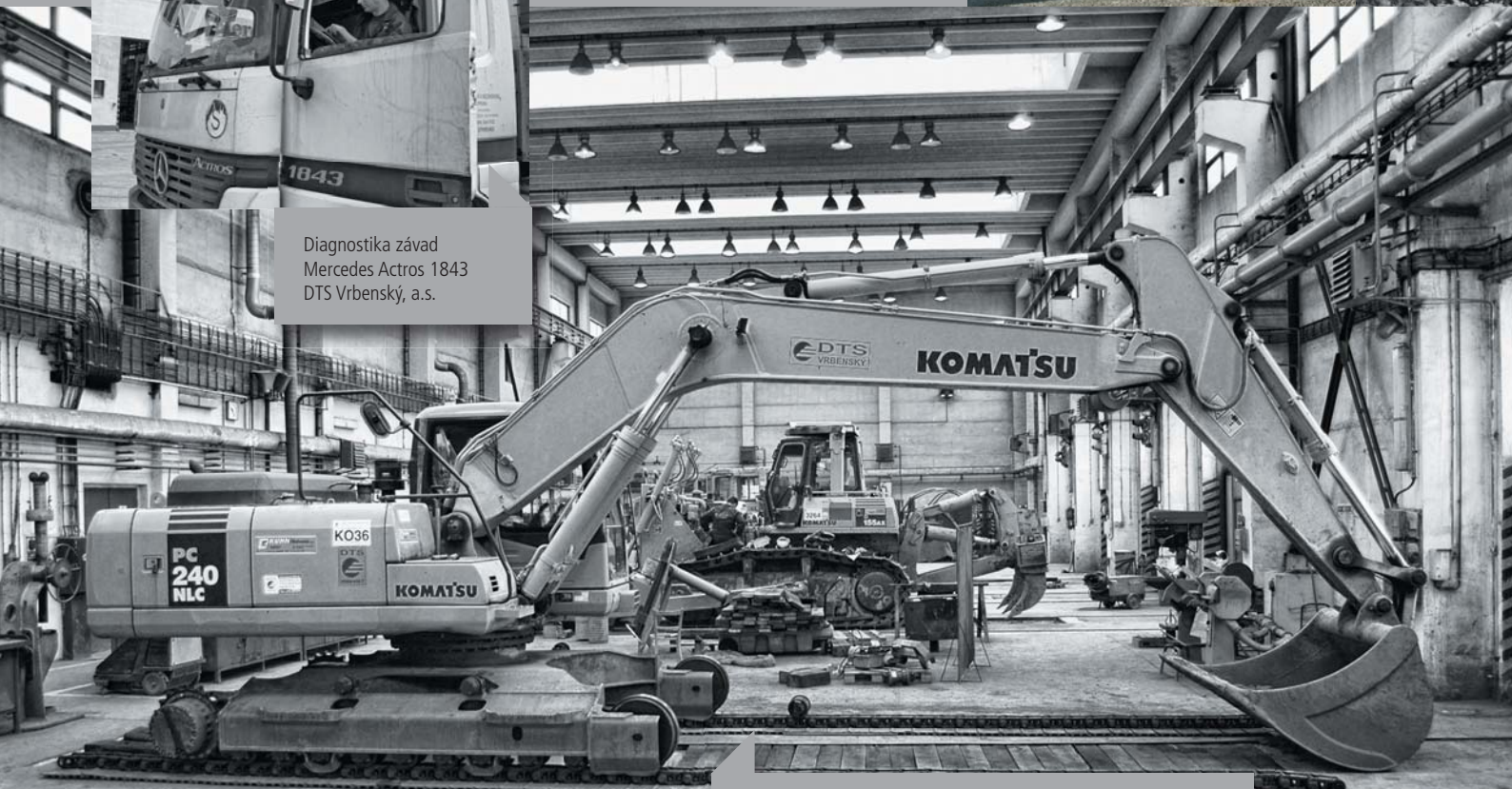
Rýpadlo Komatsu PC240 při provádění revize podvozku Provozní dílna úseku údržby lokalita Hrabák
